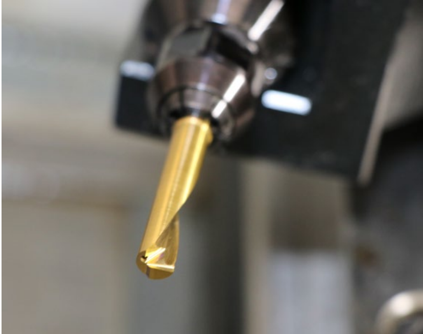
Bild 2: simturn AX zum Herstellen und Ausdrehen von Bohrungen (Bildquelle: SIMTEK AG)
